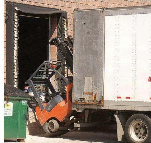
El labio especial de 20" de esta rampa funciona como protección para detener el impacto en caso de que exista un descuido del operador del equipo.
